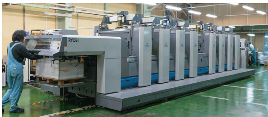
LED-UV搭載 A全判オフセット印刷機 928P
